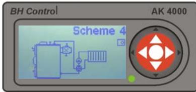
**Esquema 4** está diseñado con una válvula de 4 vías controlada manualmente. La bomba trabaja a pulsos dependiendo de la temperatura del agua de la caldera. El contacto T3 en la placa base AK4000S se usa para conectar el termostato interior
