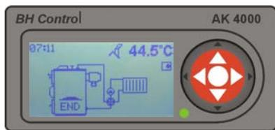
Cuando la temperatura de los gases de escape desciende por debajo de (↘ end), la caldera se apaga automáticamente. Aparecerá „END“ en el display. Presionando „ENTER“ dos veces la caldera empezará a funcionar de nuevo
