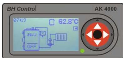
Si la caldera está en estado inactivo con el símbolo „OFF“ en la pantalla, para empezar presionar „ENTER“
