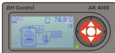
El modo quemando se activa tras el aumento de la temperatura de gases (end) +20°C. El flap servo controlado trabaja en este modo como el modo encendido. En este modo la bomba está trabajando a pulsos (protección contra baja temperatura)
