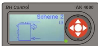
**Esquema 2** está indicado para sistemas de calefacción la protección contra retorno es controlado por un sistema externo. La bomba es conectada al control y trabaja a pulsos en función de la temperatura del agua de caldera. El contacto T3 en la placa base se utiliza para el termostato interior.
