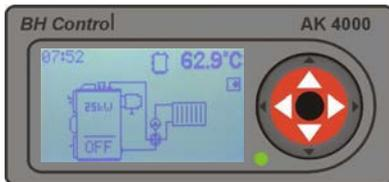
Si la caldera está en estado inactivo con el símbolo OFF, como se ve en el dibujo, presionando el botón central ENTER la caldera empieza el modo funcionamiento
