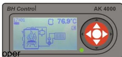
El modo quemando se activa tras el aumento de la temperatura de gases ( $\nearrow$  end) +20°C. El flap servo controlado trabaja en este modo como el modo calefacción. En este modo la bomba está trabajando a pulsos (protección contra baja temperatura). Si el símbolo de la bomba está parpadeando, la bomba está en operación
