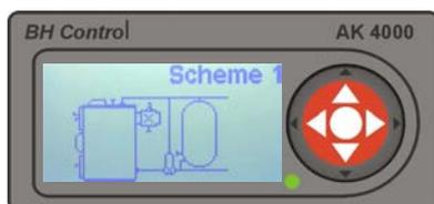
**Esquema 1** está diseñado para calderas con tanque acumulador. „LADDOMAT“ proporciona protección contra el agua de retorno. La bomba está conectada al control de la caldera y trabaja de manera continua a una temperatura sobre 40°C. Es posible cambiar el ajuste de temperatura hasta 85°C (cap.13.1.4). El contacto T3 en la placa base AK4000S se usa para conectar sonda tipo KTY para medir temperatura en el acumulador
