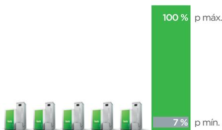
El gran rango de modulación de una instalación en cascada puede conseguir los requerimientos de potencia mucho mejor que los sistemas con un solo sistema de calefacción. Una cascada de 5 ÖkoFEN puede modular desde el 7% al 100% de la potencia de la cascada!
