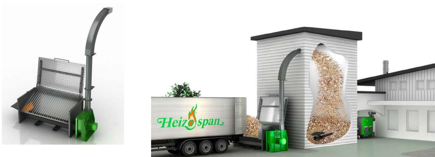
Permite **elegir las astillas hasta 10 metros de altura**. Con un motor eléctrico de 11 kW es posible alcanzar caudales de hasta 30 m<sup>3</sup>/h. El soplador se puede fabricar en **distintas alturas, según especificaciones necesarias**. Este sistema es adecuado para silos redondos o cuadrados de hasta 7 metros de diámetro.
