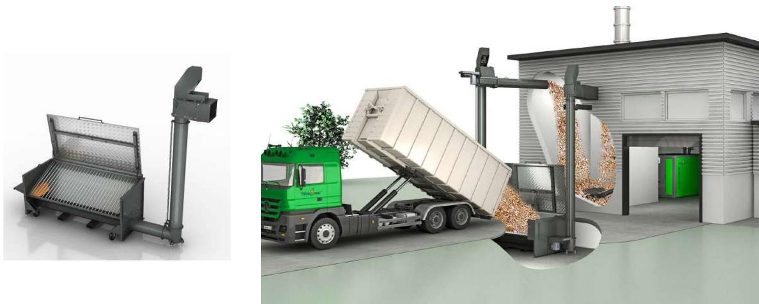
Con el elevador de astillas podemos llenar silos con una **altura de hasta 10 metros**. Con un solo motor podemos llegar a transportar **hasta 30 m<sup>3</sup> de astillas por hora** al elevador. El elevador primario sube el combustible y un segundo sinfín lo introduce en el silo. Esparciendo la astilla para un llenado completo del silo. Existe la opción de elevador doble alcanzando una descarga máxima de 60 m<sup>3</sup>/h.
